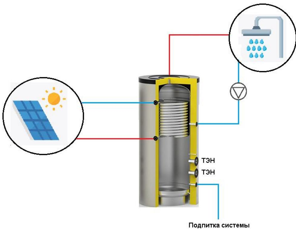
Область применения: - Накопление и аккумулирование нагретой санитарной, либо технической воды.
