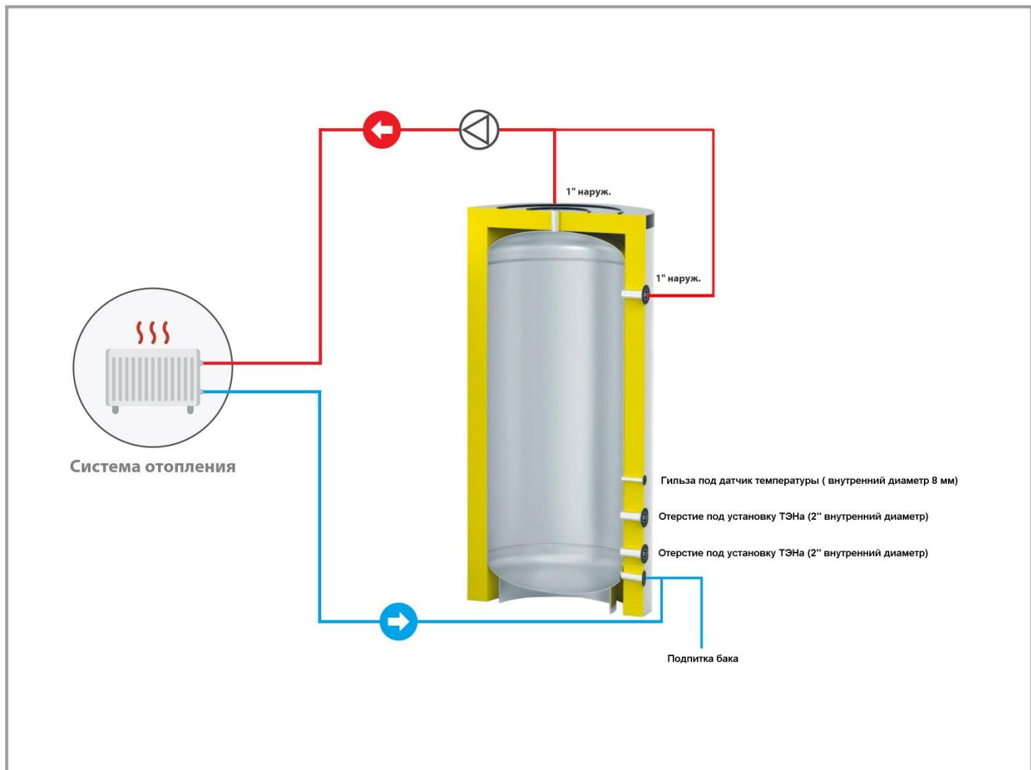
Область применения: - Аккумулирование нагретой технической воды.
